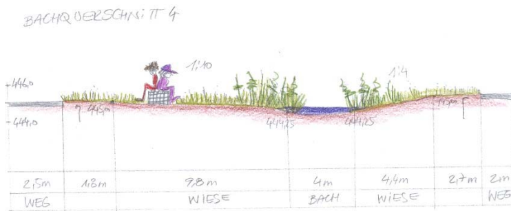
Abb. 11: Querprofile des verlegten Pfaffamadgraba mit massgeblichen Böschungsneigungen
