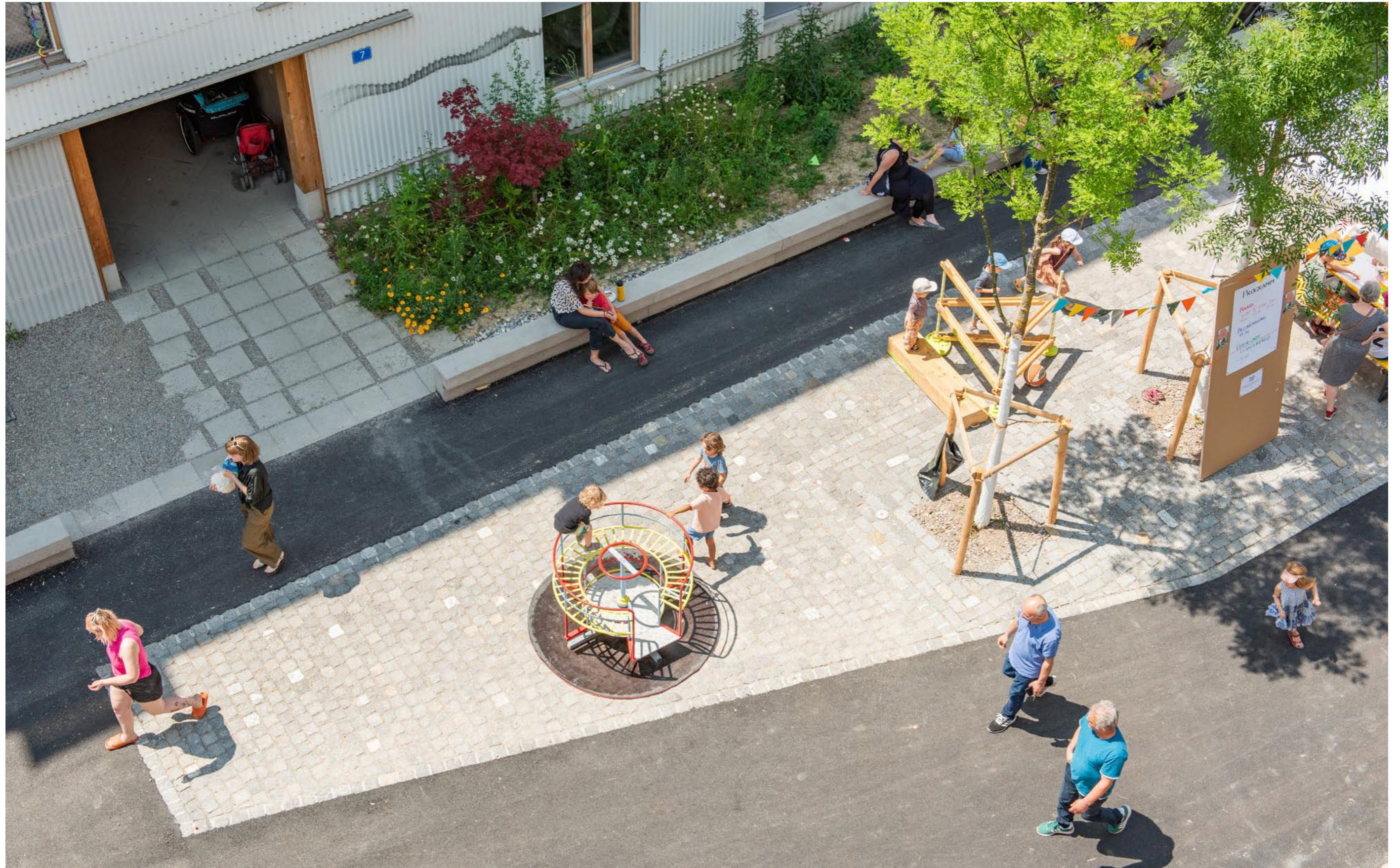
Unterschiedliche Nutzungsräume; Akzentuiert durch Belagswechsel, Sitzmauer als Schnittstelle zu den privaten Vorgärten
